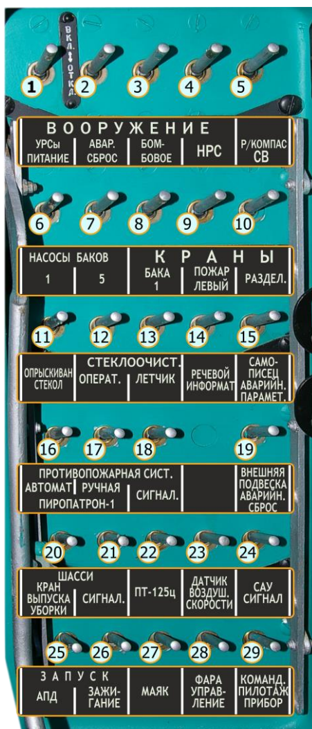
Рис. 1.2. Левая панель АЗС
