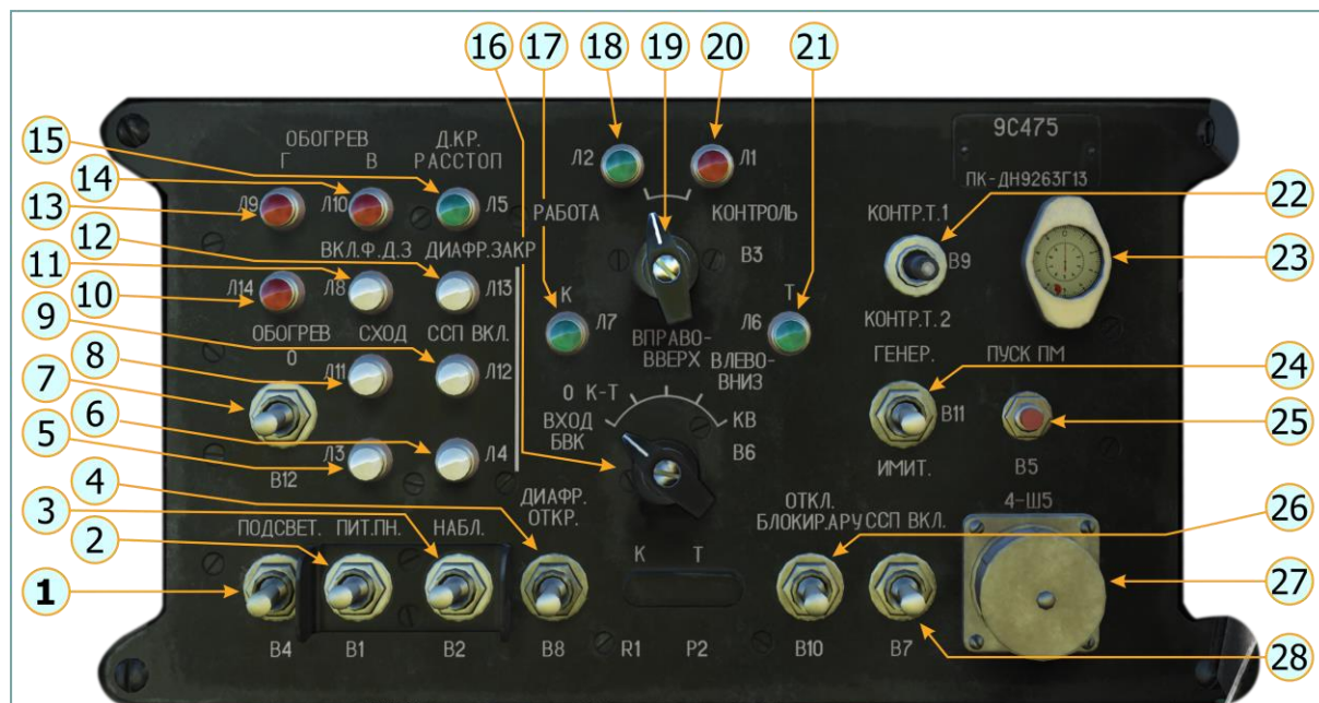
Рис. 4.21. Пульт контроля (ПК) (launch control test panel)
