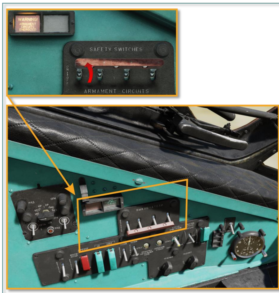
Рис. 4.12. Предохранительные выключатели и табло сигнализации их состояния
