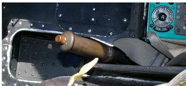
Рис. 1.14. Рычаг тормоза несущего винта
