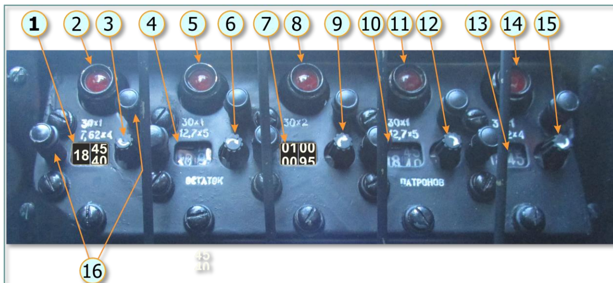
Рис. 4.11. Счетчик патронов УСБ-1-2А
